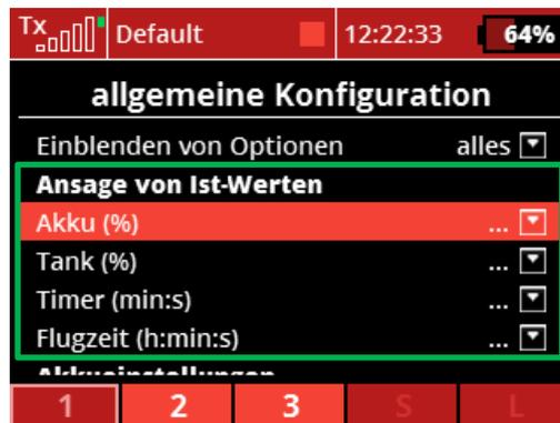
**Abbildung 6: Anzeige von Ist-Werten.** Die aktuellen Werte ausgewählter, per Telemetrie angelieferter Daten können per Sprachausgabe angesagt werden.
