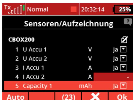
**Abbildung 28: Von der Central Box 200 gelieferte Telemetriewerte.** Von den insgesamt 8 Werten sind in der aktuellen Ansicht 5 Stück zu sehen. Die einzelnen Telemetriewerte werden anhand numerischer Telemetrieadressen unterschieden. So trägt hier beispielsweise der Ist-Strom an Eingang 2 die Telemetrieadresse „4“.
