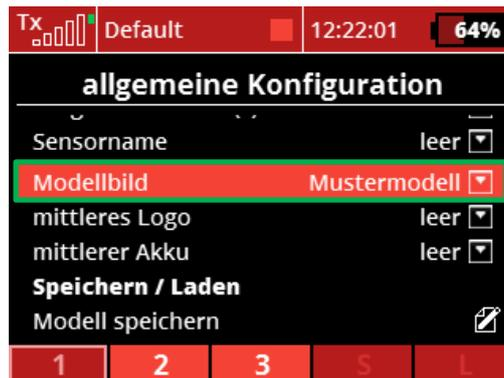
**Abbildung 21: Modellbild.** Unterstütztes Format png oder jpg in 128x60px.
