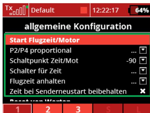
Abbildung 16: Funktion Start Flugzeit/Motor.
