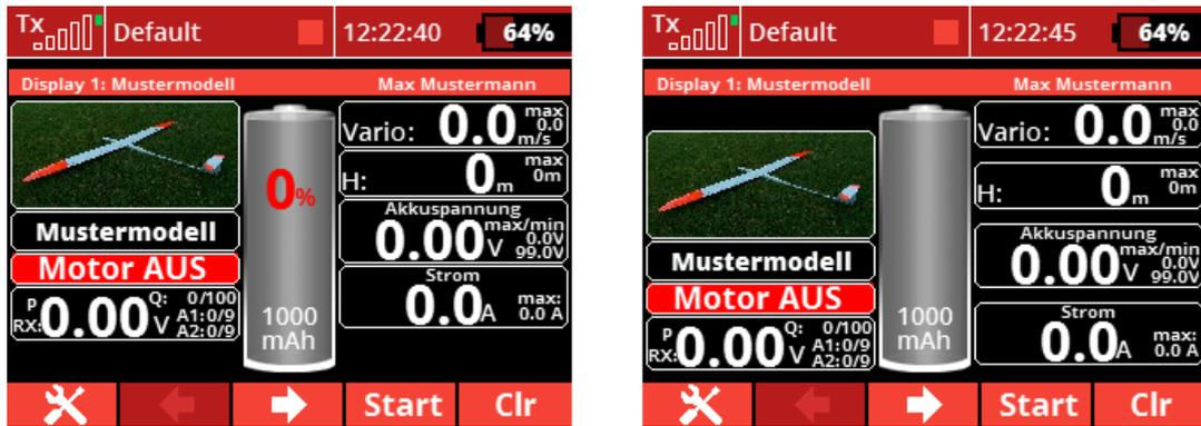
**Abbildung 32: Exemplarische Displayseite.** Links: Anzeigekacheln im Standardraster. Rechts: Linke Spalte mit erhöhtem Abstand zum oberen Displayrand und rechte Spalte mit vergrößerten Abständen zwischen den Anzeigekacheln.
