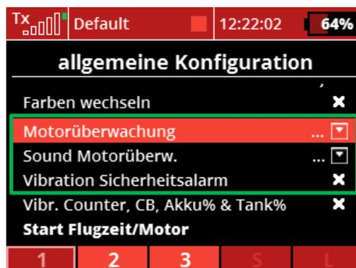
**Abbildung 14: Funktion Motorüberwachung.** Diese Funktion erlaubt die optische und akustische Überwachung des Zustands der Motorsperre der Senderfirmware.
