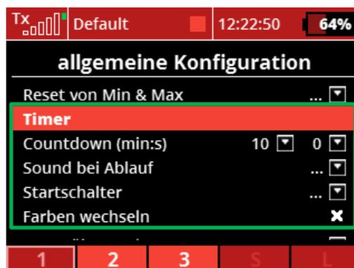
**Abbildung 13: Funktionsblock Timer.** Diese Funktion erlaubt die Definition von Timern mit Ansage bei Ablauf.
