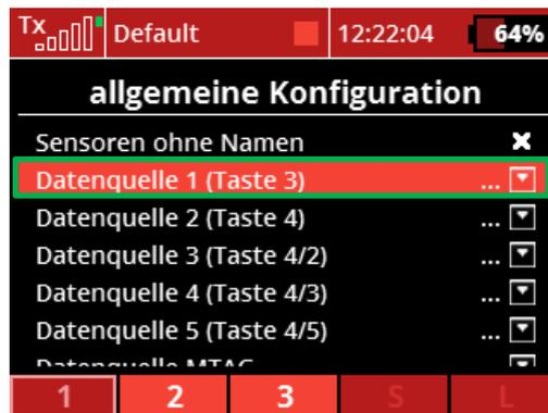
**Abbildung 3: Auswahl von Datenquellen.** Bis zu 6 verschiedene Datenquellen können gleichzeitig genutzt werden, um die Display App mit Telemetriedaten zu versorgen.
