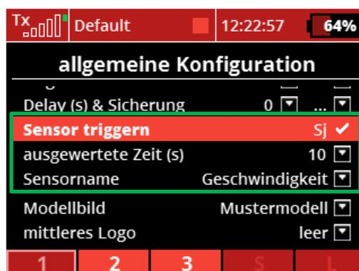
Abbildung 20: Funktion Sensor triggern. Die Funktion überwacht einen Telemetriewert über einen definierten Zeitraum und gibt das Maximum innerhalb des Zeitraums zurück.
