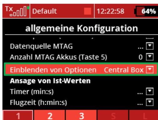
**Abbildung 5: Einblenden von Optionen.** Bestimmte Gruppen von Funktionen können je nach verwendetem Modelltyp ein- und ausgeblendet werden. Verfügbare Optionen sind „Elektro“, „Verbrenner“, „Central Box“ & „alles“.
