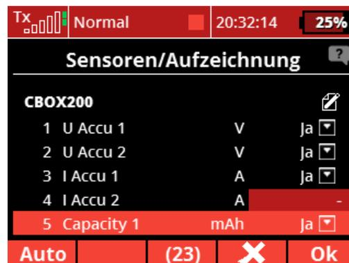
Abbildung 10: Von der Central Box 200 gelieferte Telemetrierwerte
