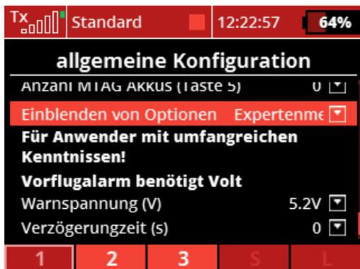
Abbildung 65: Warnspannung definiert
