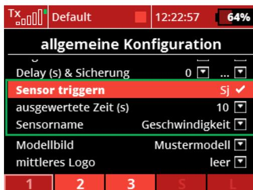
Abbildung 46: Funktionsblock *Sensor triggern*
