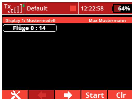
Abbildung 45: Anzeigekachel der Funktion *Flugzähler*
