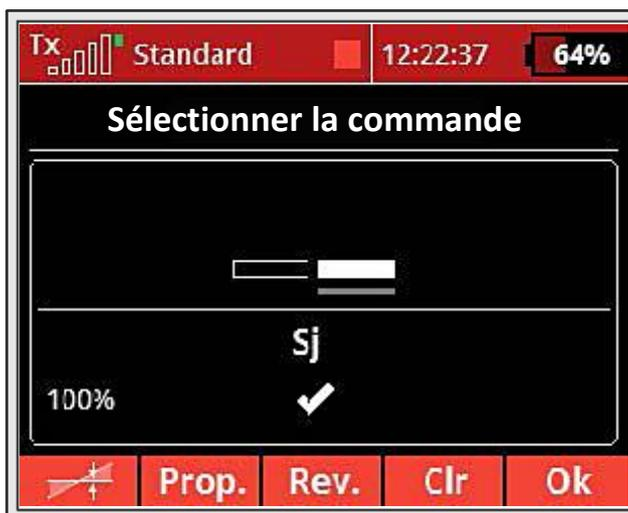
Figure 28 : Définition d'un interrupteur 2 positions
